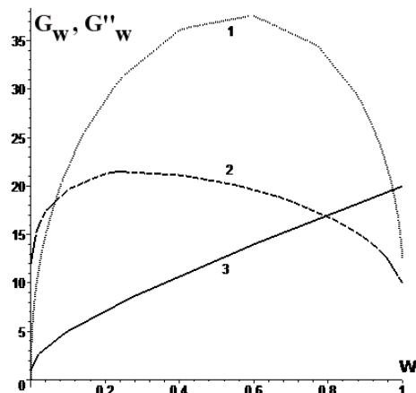
**Рис. 4.** Зависимость минимальных значений целевых функций от параметра значимости  $w$ : пунктирная кривая 1 –  $\min G'_w$  для сетей S2; прерывистая кривая 2 –  $\min G_w$  для D3 с двухпетлевым (double-loop) соединением хабов; сплошная кривая 3 –  $\min G''_w$  для D4;  $L=10^4$
